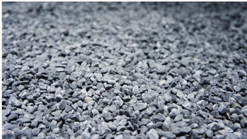
Cumple con las normas internas y especificaciones estándar para agregados para concretos, ASTM C-33.
